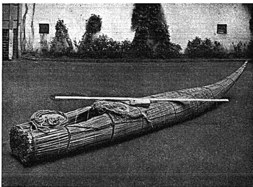
Fig. 1. En „Caballito“. peruviansk rørbåd, skænket til Nationalmusæets etnografiske samling af skibsreder Knud Lauritzen. På dækket ses paddelåren af en flækket bambusstamme, flåd af balsatræ, fiskeliner, ankertov og anker af koralblok.
