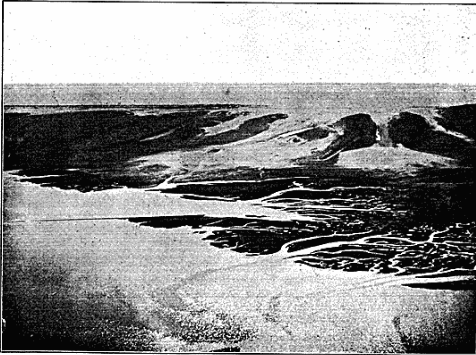
Fig. 11. Flyvefotografi fra ca. 2500 m's Højde. Sml. foregaaende Figur. Den mørke rette Linie fra Kysten ud i Ho Bugt er en Spunsvæg, hvormed man i 1905 forsøgte at kupere Ho-Bo-Dyb.
