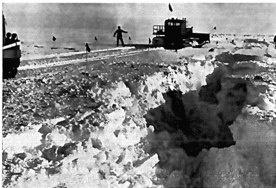
Under etableringen af Byrd stationen 1040 km SV. for Little America blev hovedmængden af materiel ført frem over isen ved hjælp af traktorer. Billedet viser afmærkning af traktor-spor nær spalteformationer, transportvanskeligheder, som øges betydeligt under de kraftige, vedvarende og hyppige snestorme i Antarktis. Foto: USIS, American Embassy
