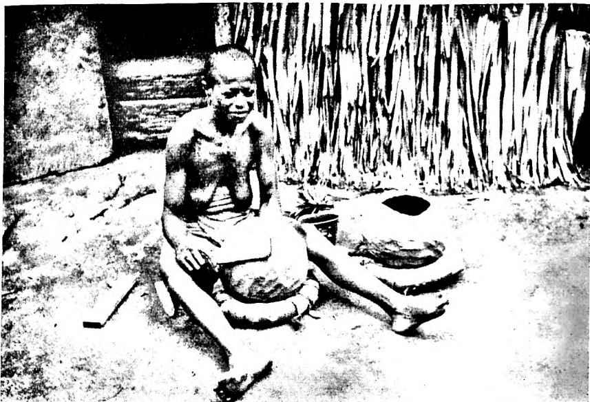
Fig. 3. Lerpotter laves på Ahus ved udhuling af en lerklump under anvendelse af den såkaldte drivteknik.
