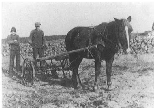
En alsidig roemaskine - en Avance - der med kørestængerne som styrestænger kunne så to lige rækker. Når såapparatet blev byttet med radrenseudstyr og til sidst med optagejern som her, var maskinen til alsidig nytte i 40-50 år.
