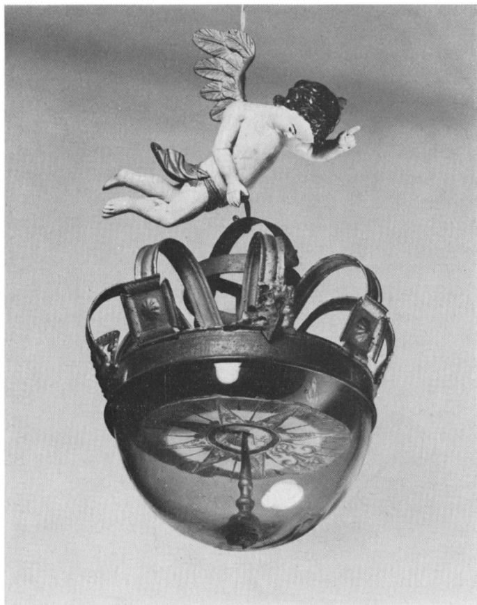
Kahytskompas fra en Grønlandsfarer. Kompasskiven af glas er inde-sluttet i en halvkugle af glas, diameter 50 cm, kongekronen af bronzeret blik, kardansk ophængning, hængende i en svævende engel med gyldne vinger, skal have tilhørt skipper Kr. Grønberg i Ho, født 1786. Foto: Museet i Brede.
