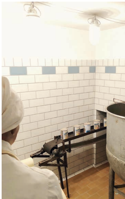
Dåser med frisklavede "Dogger Fiskeboller" kører afsted på "Esbjerg Hermetikfabrik"s transportbånd i udstillingen på Esbjerg Museum. Transportbåndet blev fremstillet på "Esbjerg Hermetikfabrik"s smedeværksted på et tidspunkt før 1960.
