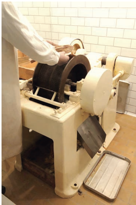
Maskine fra hermetikfabrikken udstillet på Esbjerg Museum. Maskinen skilte skind og ben fra kød på kuller og torsk, og kødet hamredes ud. Anvendt til fiskebollefremsstilling. Foto: Museum VEST (ESM 835).
