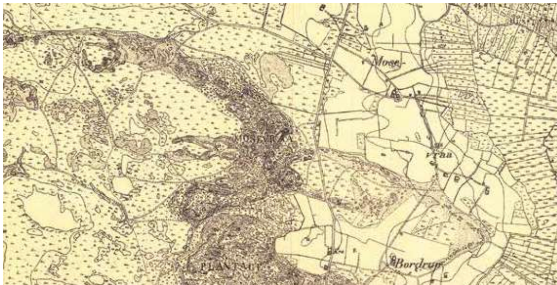
Udsnit af Generalstabens Topografiske kort fra 1870 (Ö6. Aal Kirke). Kortets ækvdistancer er vist i fod. Signatur for nåleskov i den vestlige del af Bordrup Sandes midterste parti viser, at tilplantningen af vandreklitten var påbegyndt. Ulslo ligger i slugten ca. 1.000 alen (630 m) nordvest for Bordrup Kro. © Geodatastyrelsen.
