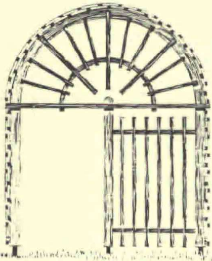
Konstruktionstegning til treillager i gårdhaven på «Gammelholm», arkitekt Søren Cock-Clausen, 1987.
