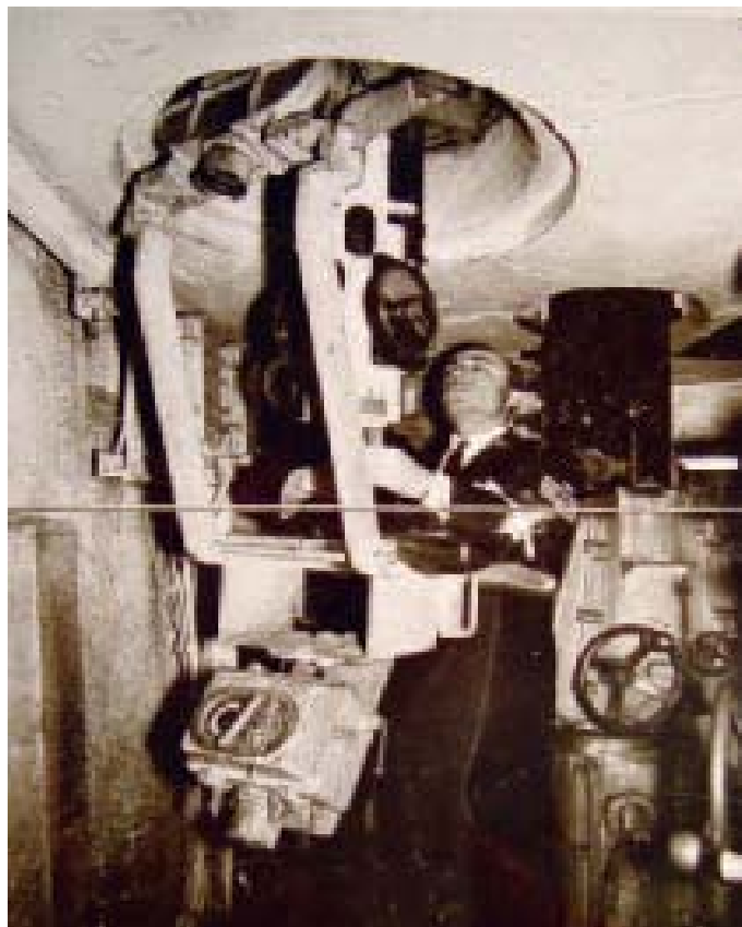
Basis-Gerät opstillet i ildledelsescentralen ombord på slagkrydseren Goeben . Operatøren af afstandsmåleren stod hvor officeren står på billedet, og meldte afstandsværdierne til hjælperen der, ved hjælp af håndtaget, indstillede de målte værdier på afsenderen nederst i billedet. (35-44 Lc. 117 Bild: 23)
