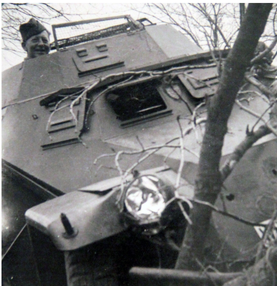
Det nye kanonmateriel kunne, hvad det var anskaffet til. Her en let panservogn (Sd.Kfz. 221) med frontpanseret gennembrudt af to panserskud fra en 20 mm Madsen maskinkanon den 9. april (en af de fire standsede panservogne ved Bredevad). (Foto: Rigsarkivet).
