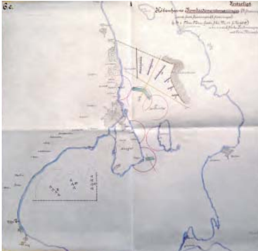
Plan fra november 1911 visende de planlagte A(nløbs)-spærringer (grøn skravering), de tilsvarende planlagte B(ombardements)-spærringer samt med røde cirkler skudvinklerne for forternes skyts. (Skitse: Rigsarkivet)
