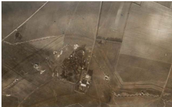
Luftfotografi fra Sikringsstilling Nord, der sandsynligvis er taget efteråret 1916. Det viser den næsten færdige forreste skyttegrav, et stykke af en fremskudt grav samt lidt af anden skyttegrav. Forbindelsesgravene kan kun anes. (Fotoet tilhører Johannes Bruchhof). Til højre kortudsnit visende samme stykke for forreste stillingslinje syd for Bevtoft. (Del af kort over skyttegravenes forløb mellem Gøttrup og Over Jerstal. Kortet tilhører Støtteforeningen for Sikringsstilling Nord)
