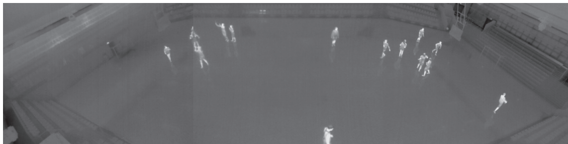
Figur 1: Eksempel på termisk billede fra en idrætshal, hvor de enkelte mennesker træder frem som lyse objekter på en mørk baggrund. (Foto: Aalborg Universitet)
