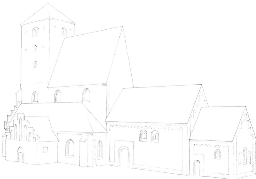
Fig.5. Nakskov kirke , Maribo amt. Rekonstruktion (ved Aage Roussell) af bygningens tilstand i perioden fra 1400'ernes midte til begyndelsen af 1600'erne. Til højre den senromanske teglstenskirke (kor og skib), der ikke blot fungerede, mens første etape af det store, gotiske byggeri gennemførtes ved skibets vestende, men også i de cirka halvandet hundrede år, som forløb, inden dette arbejdes anden og sidste del fuldendtes. På tegningen er dog udeladt de sideskibsmure, som i umiddelbar fortsættelse af det gotiske vestafsnit førtes omkring den senromanske bygning. Arealet mellem disse mure og den gamle kirkebygning benyttedes som regulær kirkegård, indtil kirkens ombygning fuldførtes i 1600'erne.
