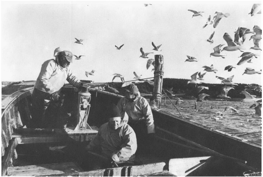
Jolle fra Grenaa-Ebeltoft Bundgarnsselskab. De hydrauliske spilkopper har lettet det tunge arbejde med at hive netbund og ruser op under røgning. Foto: T. Vestergaard, Dansk Fiskerimuseum.
