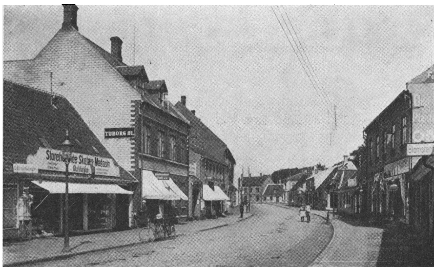
Fig. 15. Algade, hovedgaden i St. Heddinge, ca. 1925. Gaden er endnu præget af de lave længer, der i 1700 årene har stået som bindingsværksbyggede, stråttækte huse. Den lave bygning til højre i billedet ud for lygtepælen og de to skolebørn er for størstedelen bygget af bindingsværk med kridtstensudmuring. For enden af gaden ses den tidligere rytterskole, der ifølge brandtaksationerne fra 1761 var en af de få grundmurede kridtstensbygninger, der dengang fandtes i byen. De øvrige lave huse er for de flestes vedkommende grundmurede kridtstenshuse af senere dato. Det høje hus til venstre med slagterforretningen er bygget af kridtsten, men selve facaden er af de finere, »importerede« teglsten. Denne facade-muring med teglsten ses på flere af byens kridtstenshuse. De øvrige høje huse på billedet er enten helt beklædt med, eller bygget af, teglsten. Fot. fotograf Hansen, St. Heddinge.
