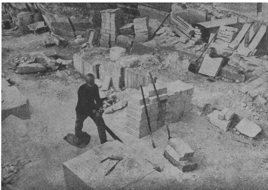
Fig. 3. Samme »stensker«, som ses på fig. 2. Stenskerer Anders Pedersen i færd med at udsave en stor kridtstensblok. I forgrunden ses det firkantede udhuggede hul, som der saves hen til. Op ad stablen med færdige kridtsten står »huggejern« og »oprager«. Ovenpå blokken ses et par stykker værktøj. Det drejer sig formodentlig om en vinkel og et stregemål. Anders Pedersens højre fod hviler på en gammel sæk, som brugtes til at beskytte knæene, når man til sidst, knælende, skulle save det sidste stykke ned mod flintlaget. Foruden mange færdige »hele« kridtsten af den sædvanlige størrelse ses flere »halve« og »kvarte« sten. Bagest i billedet, op ad klintvæggen ses affaldssten – de såkaldte »klodser«, som stenskererne i nyere tid havde lov til at sælge for egen regning. Illustration fra bogen »Faxe Kalkbrud gennem 50 år«. 1934.
