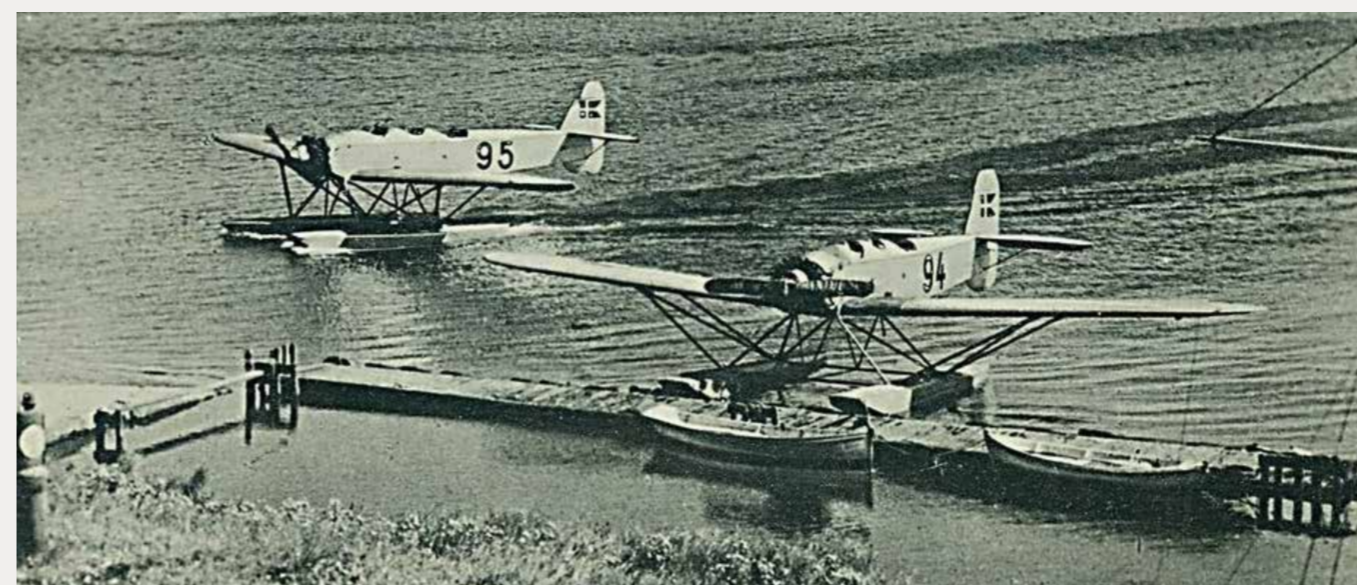
Fig. 9. To Heinkel H.E. 8 vandflyvere ved slæbestedet i slutningen af 1930'erne. Seks af disse rekognosceringsmaskiner blev indkøbt i Tyskland i 1928, og efterfølgende blev der bygget 16 stk. på licens på Orlogsværftet. Postkort.
