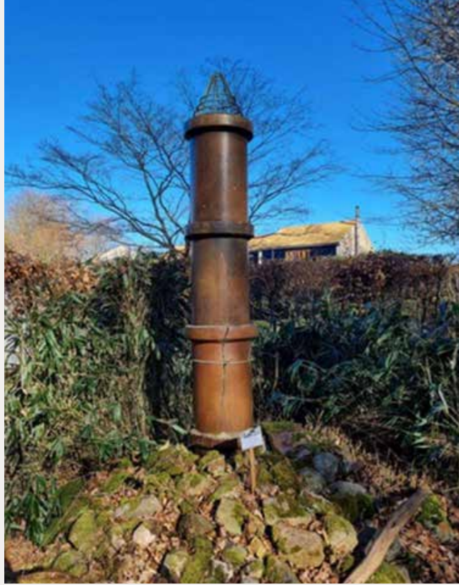
Ekspansionsrør var en del af klædefabrikens vandkraftssystem. Anvendt for udligne trykket i vandrørene, når der blev lukket for vandet. Foto Søren Agerlund.
