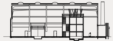
Fig. 20. Vandflyverhangaren. Snit B-B. I:300 Dorte Mandrup Arkitekter.
