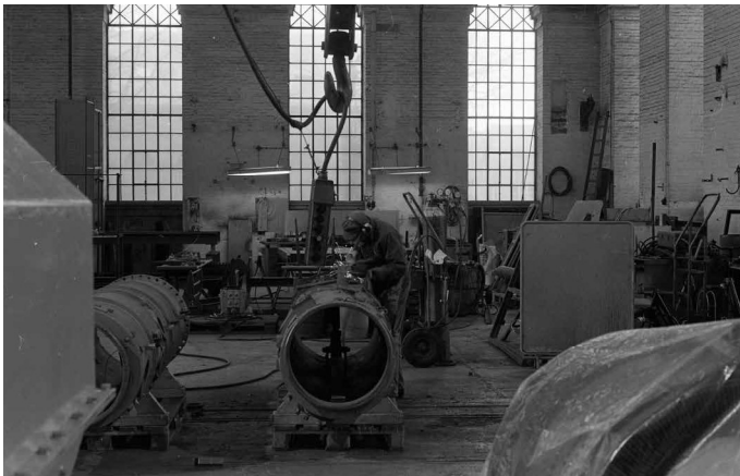
I kedelsmedien er en håndværker i gang med at vinkelslibe på et torpedorør med en tryklufsdrevet vinkelsliber. På billedet fornemmer man det katedralagtige udtryk fra vinduespartierne. Film nr. 25, billede nr. 18, reg. Nr. 1502:1990.
