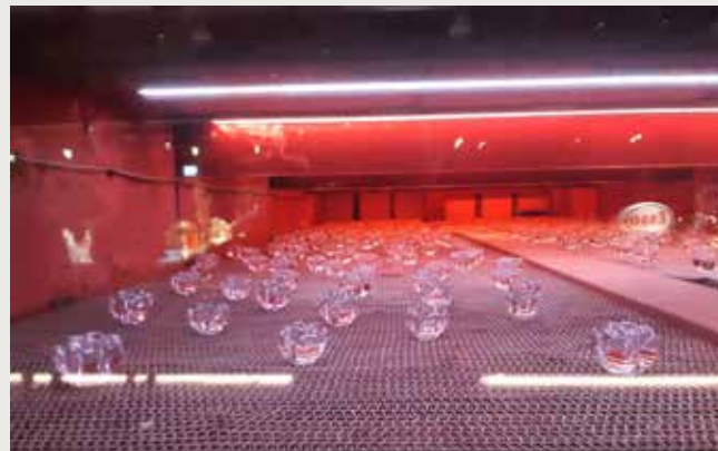
Fig. 19. Kølebåndet, hvor de færdige glasmønstre langsomt tempereres, så sprængninger undgås. Foto: JHC 2022.
