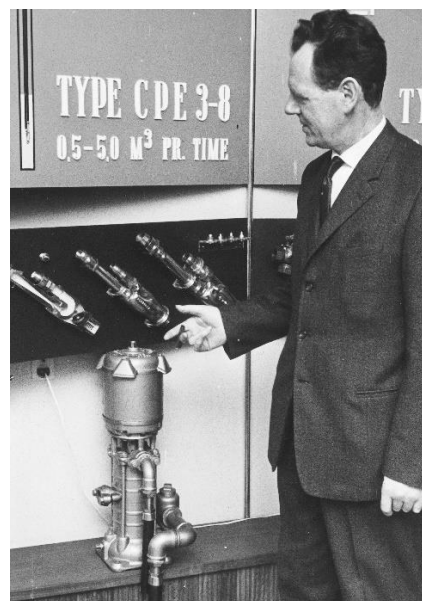
Pladskrævende og materialetunge stempelpumper i 1950 og den meget mindre centrifugalpumpe i 1959 ved siden af Poul Due Jensen. Centrifugalpumpens mindre dele muliggjorde rationalisering af produktionen.
