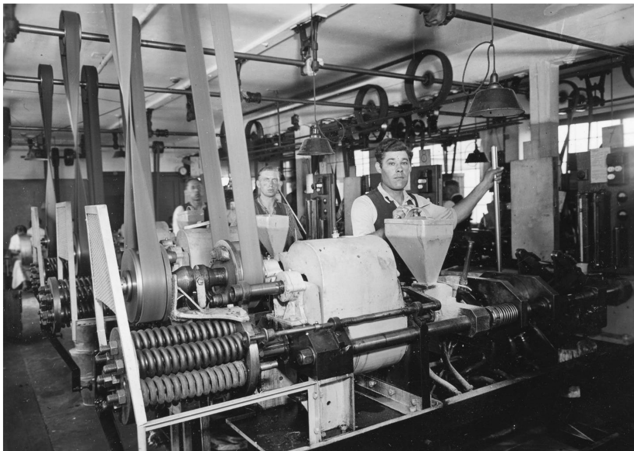
Arbejdere ved sprøjtestøbmaskinerne i Nokalon-afdelingen på Nordisk Kamfabrik – pioneren inden for plastsprøjtestøbning. Foto fra 1940'erne. Ukendt fotograf. Vordingborg Lokalhistoriske Arkiv.
