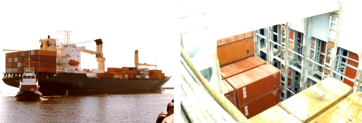
Containerskibene var pænt store efter datidens skala. Her er det vesttyske "Marcon" i charter til DSR. Til højre ses hvordan containerne lastes i såkaldte celler, hvor lastningen styres i en slags skinner, og det er ikke nødvendigt at surre containerne i lasten. Fotos: Ole Ryolf.
