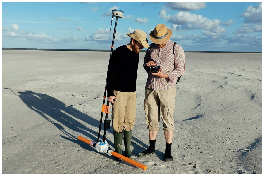
Abb. 4. Anwendung Elektromagnetischer Induktionsmessungen auf Japsand.
