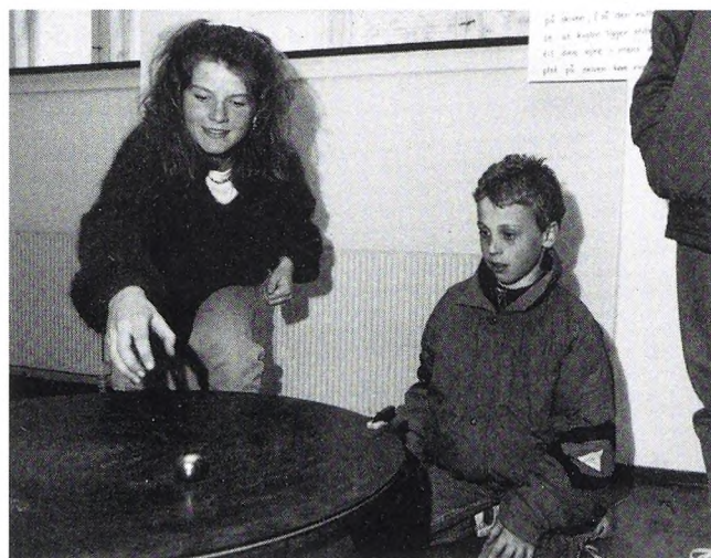
Figur 2. Den store sorte drejeskive sættes i rotation. Lægges en stålkugle forsigtigt på den roterende drejeskive, kan den rotere i en cirkel rundt på drejeskiven set fra laboratoriesystemet.
