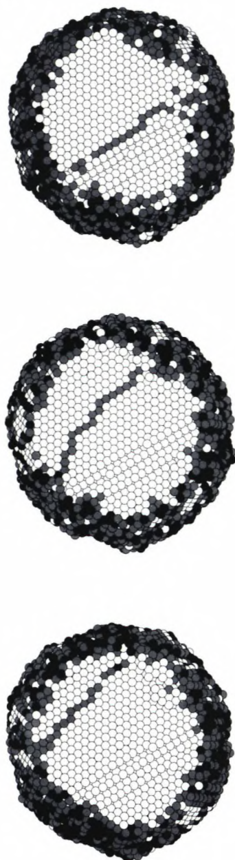
Figur 5. En dislokation i en kobber-klynge. Dislokationslinjen er grå. De grå områder ved overfladen skyldes, at den uordnede struktur i de øverste lag forvirrer den algoritme, der finder dislokationen. I området over dislokationen er en stabelfejl (kan ikke ses på denne figur). Stabelfejlen fjernes, når dislokationen bevæger sig ud af klyngen. Sekvensen tager cirka 13 picosekunder.
