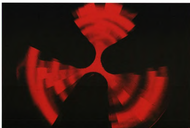
Figur 7. En laserstråle sendes ind fra venstre. Fotografisk optagelse af det spredte lys.
