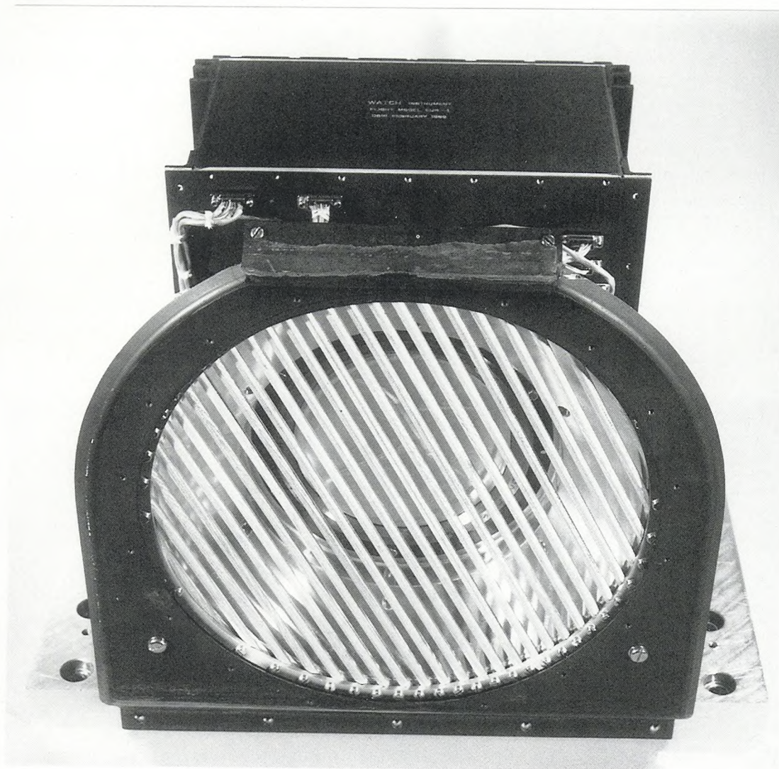
Figur 5. WATCH instrumentet fra Dansk Rumforskningsinstitut. Instrumentets fulde navn er Wide Angle Telescope for Hard Cosmic X-rays. Det cirkulære gitter med en diameter på 25 cm roterer en gang i sekundet under hele flyvningen. Gitteret danner et røntgenlys-skyggemønster på detektoren. En analyse af mønsterets tidlige forløb angiver røntgenkildernes placering paa himlen. Instrumentet vejer 11 kg og bruger 12 W.
