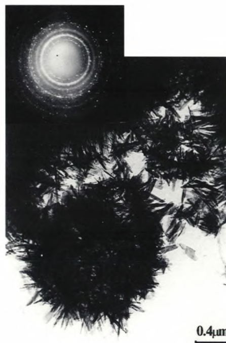
Figur 5. Til venstre fasekontrastmikrofotografi, til højre transmissions-elektronmikrofotografi med elektrondiffraktogram af produkt fra jordbaseret referenceforsøg.
