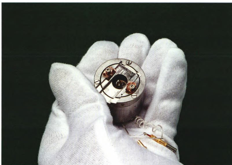
Figur 2. Vores STM. 1) Prøve, 2) Prøveholder, 3) Fjeder, 4) Wolfram-nål, 5) Nålholder, 6) Scannerrør, 7) Aksel, 8) Piezo-motor, 9) Fastgørelse og 10) Kvartskugle. Læg mærke til de små dimensioner. Billedet til højre viser et fotografi af instrumentet.
