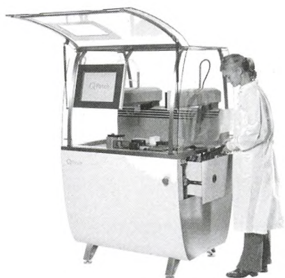
Figur 1. Billede af QPatch™ screening station til automatisk patch clamping.
