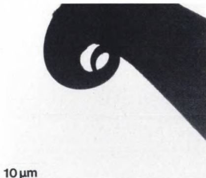
Figur 1. Wolframspids til scanningtunnelmikroskopet, som er blevet bøjlet under brug.
