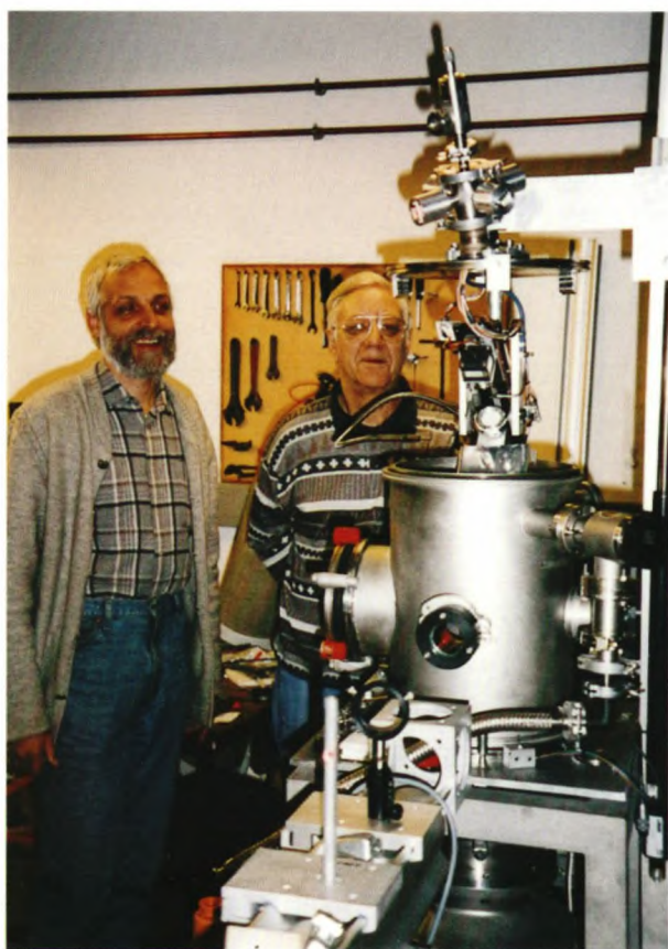
Figur 7. Foto af opstillingen på Risø til tyndfilmsproduktion med laser ablation. Target, en metalgrå skive lige over kanten, og substratholder er midlertidigt løftet op fra kammeret. Laseren kommer ind i kammeret fra foran i billedet gennem linse og kammervindue. I baggrunden forskningstekniker Arne Nordskov og artiklens forfatter, Jørgen Schou, Risø. (Foto: Birgitte Thestrup)
