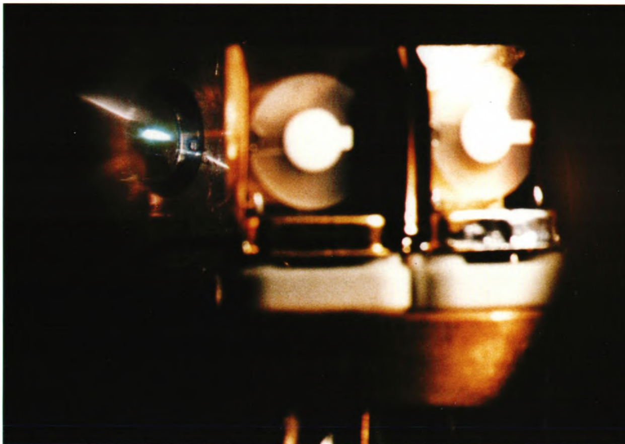
Figur 4. Et stærkt lysende (blåligt) sølvplasma i vakuum foran target ses til venstre på figuren. Laserpulsen på 355 nm (kan ikke ses) kommer ind fra venstre. Pulseenergien på 50 mJ og længde 6 ns giver her til en intensitet på 0.5 GW/cm 2 . De "tallerken- lignende" to plader til højre er mikrovægte på holdere, der bruges til måling af hvor meget sølv, der udsendes fra target. Billedet stammer fra en optagelse på Risø.
