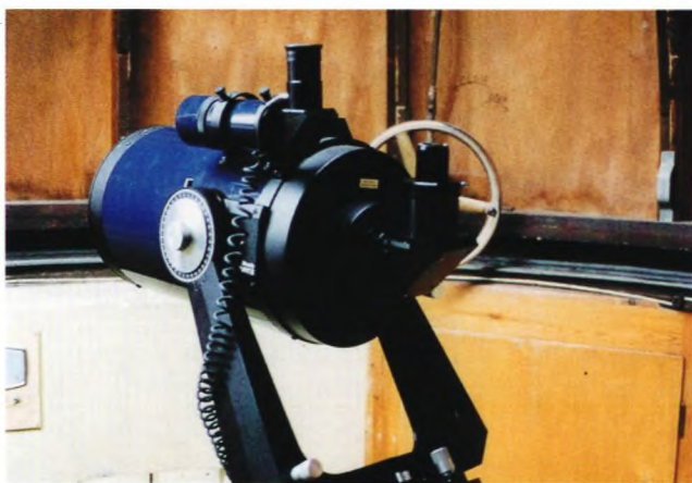
Figur 2. Astronomisk Selskab fik i begyndelsen af 1980'erne to 20 cm Meade LX3 teleskoper med tilhørende fotoelektriske fotometre. Et af disse er opstillet i observatoriet. Takket være den kompakte Schmidt-Cassegrain optik er der god plads, selvom teleskopet har en brændvidde på to meter.
