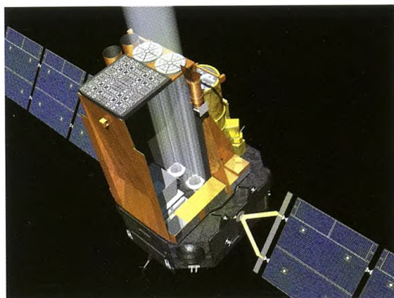
Figur 1. INTEGRAL-satellitten medfører to hovedinstrumenter til gamma-astronomi. Dertil kommer et sæt af mindre Røntgenteleskoper og en optisk monitor. Alle Røntgen- og gammainstrumenter benytter de såkaldte "kodede masker" til at tage billeder af gammakilderne på himlen.
