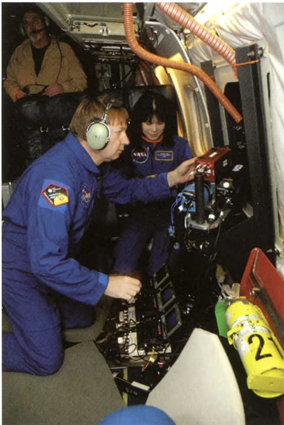
Figur 2. Mike Taylor og Mitsumu Ejiri fra Utah State University i færd med at kalibrere de optiske instrumenter ombord på University of North Dakota's DC-8 (tidligere NASAs flyvende observatorium).
