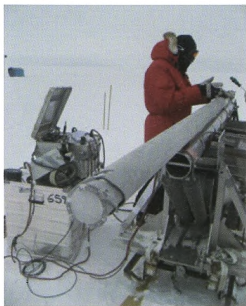
Figur 5. Boret henter iskernerne op i stænger på op til tre meter ad gangen.
