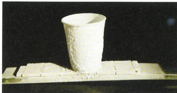
Figur 3. Forsøgsopstillingen til nedkøling af superleder på magnetbanen. Superlederen befinder sig nede i koppen sammen med flydende nitrogen. Foto: Palle Demant.
