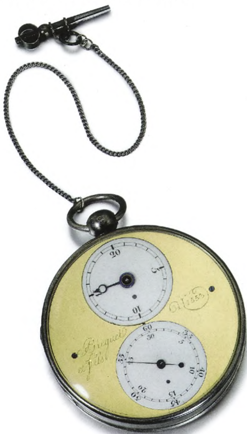
Figur 3. Observationsur til astronomisk brug, fremstillet i Paris af den franske urmager Abraham Louis Breguet.
