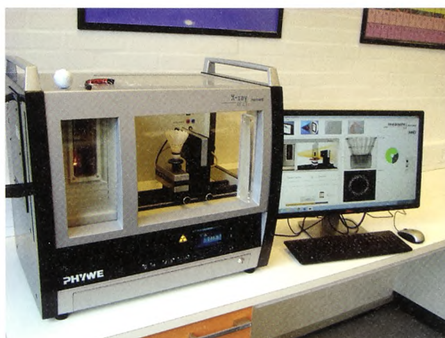
Figur 1. Et af Nanotekets røntgenapparater sat op til CT-skanning af fjerbold. Røntgenrøret sidder til venstre, og man aner katoden gløde orange. Bolden roteres, og man optager fx 200 projektioner fra forskellige vinkler. Disse behandles i computeren, og en 3D-rekonstruktion dannes.
