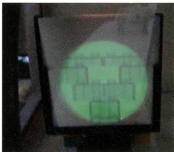
Figur 4. Klassisk røntgenbillede taget med fluorescerende skærm monteret i apparatet i stedet for den elektroniske skærm i figur 1.
