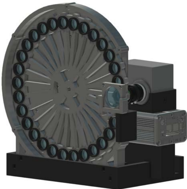
Figur 1. 3D-rendering af det multispektrale system bestående af filterhjulet med 30 båndpasfiltre og et kamera med en IMX990 billedsensor. Det yderste lag er fjernet, så filtrene kan ses. Et yderligere filter foran hjulet sikrer de ønskede spektrale responser.
