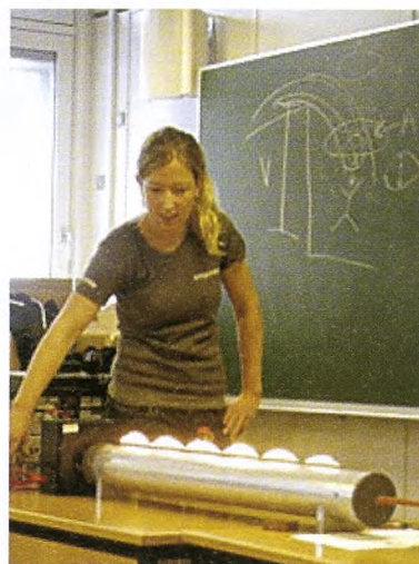
Figur 1. Line Kyhl demonstrer Rubens flammerør, hvor lødbølger sendes ind i et gasfyldt rør med små huller langs toppen. På den måde kan man se stående bølger i røret (som på billedet), eller man kan sende musik ind og se en flamme-equalizer.
