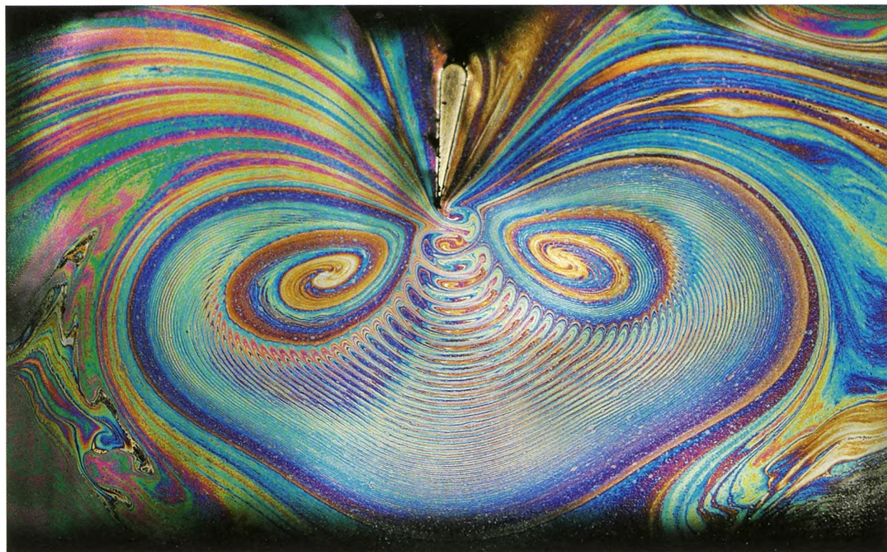
Figur 3. Viftestrøm frembragt af finnen i den vandrette sæbefilm [7]. Se også billedet på forsiden.
