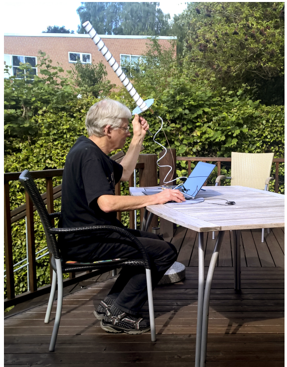
Figur 4. Modtagning af Ørsted signaler med håndholdt helix-antenne (privatfoto).
