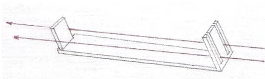
Figur 9. Øverst: Tychos lille kvadrant af forgyldt messing, 39 cm radius (ikke diameter som på s. 59 i [2]), bygget 1574, træsnit ca. 1598 i [6]. Nederst: Tychos nye sigtemiddel med spalter, der giver parallelle sigteretninger til stjernen.
