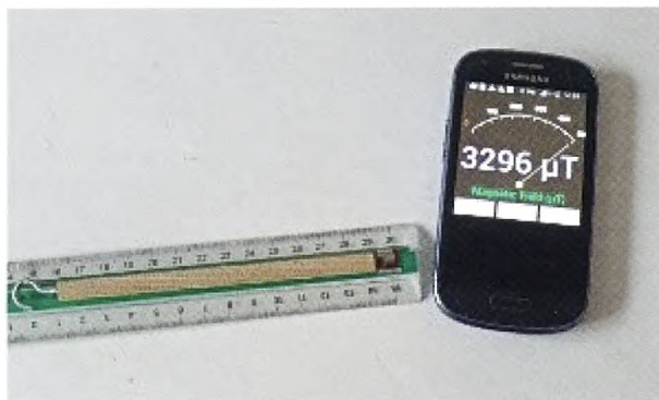
Figur 9. Mobiltelefon med indbygget Hallsonde.
