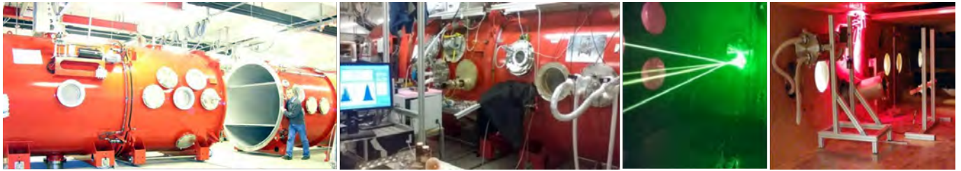
Figur 1. Forskellige billeder af Aarhus planetsimulatorfaciliteten, som er bygget i samarbejde med LM-Stål (Randers). Fra venstre mod højre ses: kammer under lukningsproces, måling med kryokøling med flydende kvælstof og laser Doppler-velocimeter- (LDV-) målinger samt LDV-stråler set indefra i simulatoren (som oplyser vindbårne støv-aerosoler).
