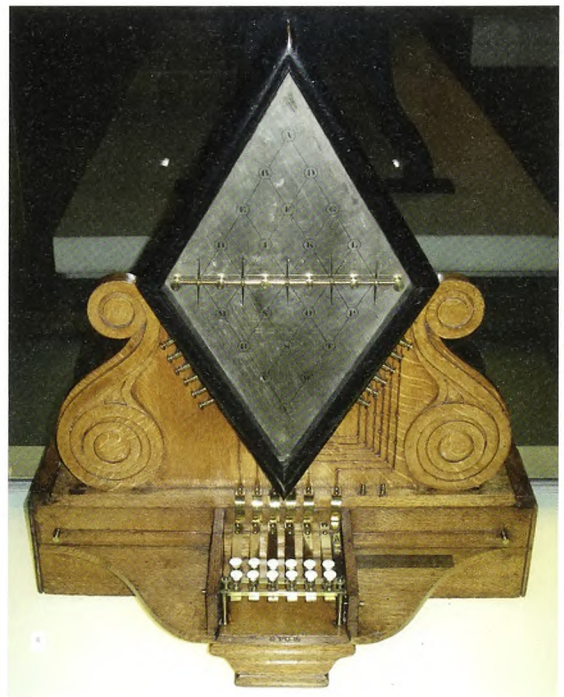
Figur 9. Cooke og Wheatstone brugte den elektromagnetiske effekt til at bevæge nåle i deres telegraf. Denne har fem nåle, som ved fælles hjælp kan pege på ethvert bogstav i alfabetet. Foto: Wikicommons.
