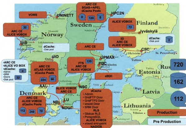
Figur 3. Oversigt over NDGF's tjenester og ressourcer ved de nordiske computercentre. Symbolforklaring: Rektangler angiver CPU-kapacitet i "Kilo Specmarks Integer year 2000", svarende til 1 standard-CPU anno 2004. Cylindre angiver Disk-kapacitet i TB. "Talebobler" angiver Båndkapacitet i TB. Alle tallene vokser hurtigt og skal ganges med en faktor 2-3 i dag. "Preproduction" hentyder til de test NDGF laver af ny software før de installerer den på "Production"-infrastrukturen. Kilde: [7].
